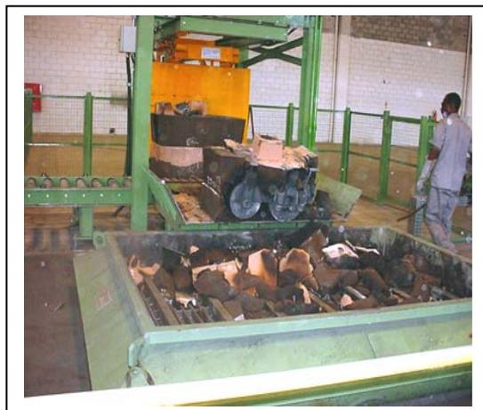
Figura 23 - Desmoldagem
