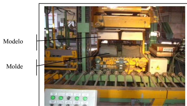
Figura 18 - Molde e modelo (momento do destacamento)
