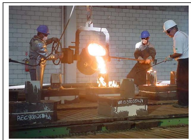
Figura 22 - Vazamento do metal líquido no molde
